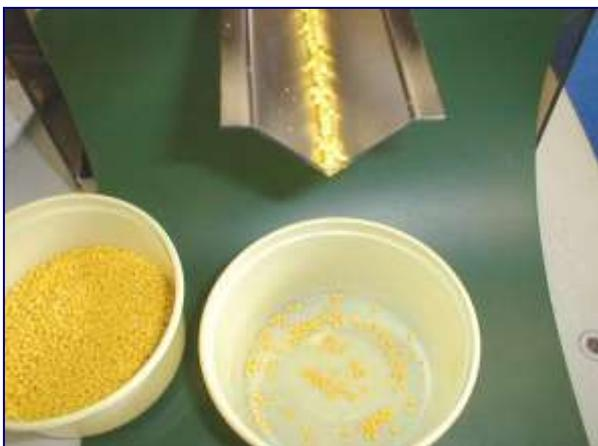
Rinnenbelegung bei einer Dosierleistung von 0,1 kg / h
