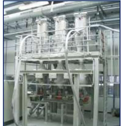
5-Komponenten Dosierstation mit Förderanlage
