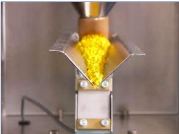
Rinnenbelegung bei einer Dosierleistung von 10 kg / h
