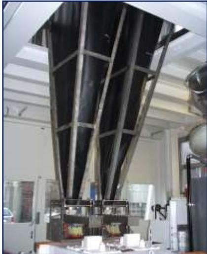
Tandem Dosiereinheit mit Flexbehältern
