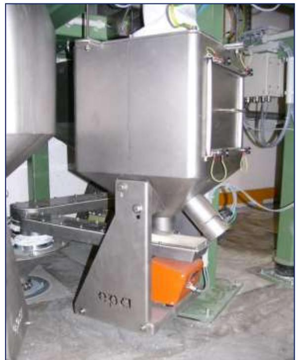
7 Komponenten Dosieranlage für Kleinmengendosierung
