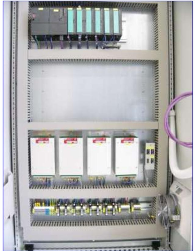
Schaltschrank für eine 4-Komponenten Dosieranlage mit 4 Endstufen für Vibrationsantriebe. Inklusive Koppelrelais für eine kundenseitige Förderanlage. In der Fronttür ist hinter einem Sichtfenster der Monitor eingebaut. Die Tastatur mit Maus befindet sich in einer Schublade.
